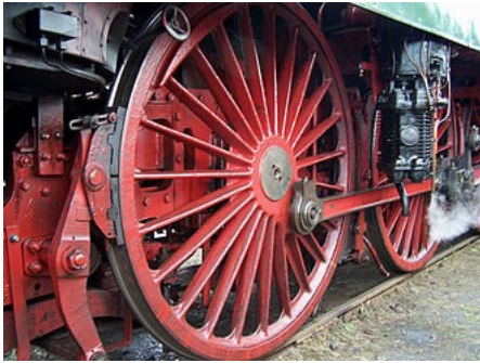
Treibräder der 18 201 mit 2300 mm Durchmesser
