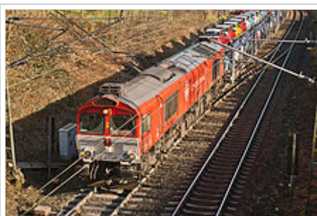
Eine JT42CWRM der CrossRail Benelux, man beachte die dreitürige rechte Lokseite
