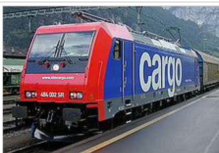
Viersystemlok SBB Re 484
