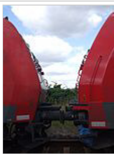
Vergleich der Kopfform einer 185.1 und 185.2
